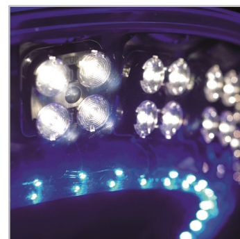
Cele 64 de LED-uri cu lumină albă de mare putere, distribuite pe 16 module, sunt orientate independent și înclinate în funcție de tipul de distribuție luminoasă necesară.
