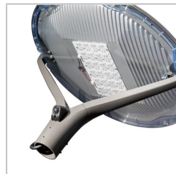
Oyo se montează montaj prin alunecare pe un stut cu diametrul 60mm prin intermediul a 6 șuruburi M8.
