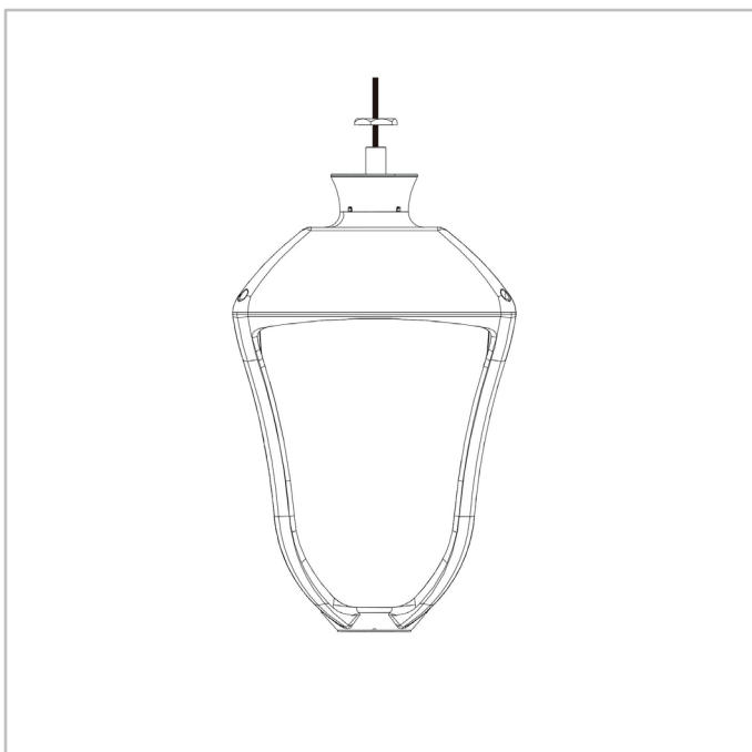
STYLAGE | Montaj suspendat cu fixare pe țevă filetată mamă de 1"
