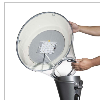
CALLA LED se montează prin alunecare pe un ștuț de Ø60 sau 76mm.
