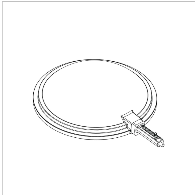
CITEA NG2 | Montaj lateral cu articulații cu alunecare pe ștuț neted Ø60mm (A6)
