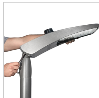
Unghiul de înclinare poate fi reglat la fața locului, atât pentru configurațiile în vârf de stâlp (de la 0 la +15°), cât și pentru cele cu montaj lateral (de la 0 la -15°).
