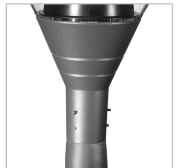
Acest aparat de iluminat se montează în vârf de stâlp prin intermediul unui ștuț cu diametrul de Ø60mm.
